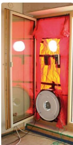
1. Les ouvertures volontaires (portes, fenêtres, trappes ...) et obturables (cf. la hotte...). Les conduits de ventilation sont scellés.
